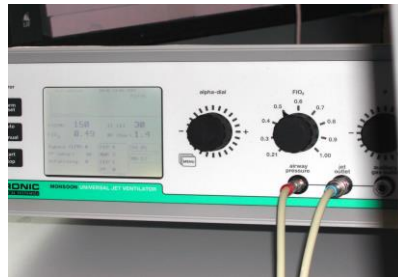
Luer-Lock-koppling som möjliggör jetventilation
